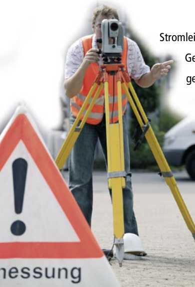
Vermessungstechniker mit einem „Tachymeter-Theodolit“.
