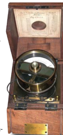
Isolations-Meßgerät aus dem Jahre 1904.
